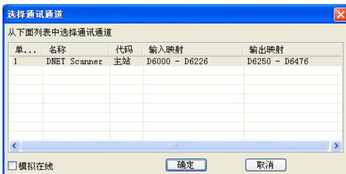
(4) 点击“确定”按钮，DeviceNetBuilder 软件开始对整个网络进行扫描，如图所示：
