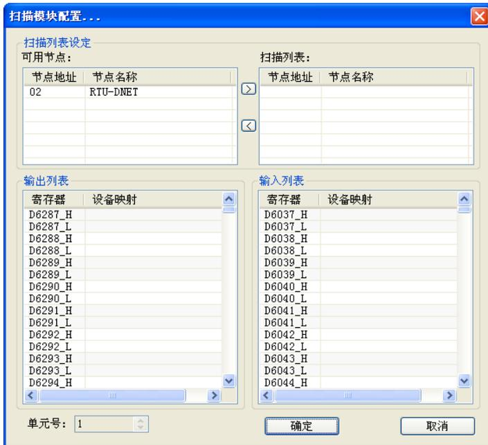
4. 点击“是”按钮，将配置下载至扫描模块，确认 PLC 处于 RUN 模式。可以看到 RTU-DNET 模块的“MS 指示灯”和“NS 指示灯”呈现绿色常亮状态，DVPDNET 的“MS 指示灯”和“NS 指示灯”也呈现绿色常亮状态，DVPDNET 的 LED 数码管显示“01”。
