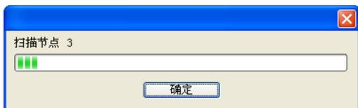
(5) 如果上述对话框的进度条一直没有动作，则说明 PC 和 SV PLC 通讯连接不正常或 PC 上有其它程序使用串口。扫描结束后，会提示“扫描网络已完成”。此时，网络中被扫描到的所有节点的图标和设备名称都会显示在软件接口上，如下图所示。在此例中 RTUDNET 的节点地址为 0。
