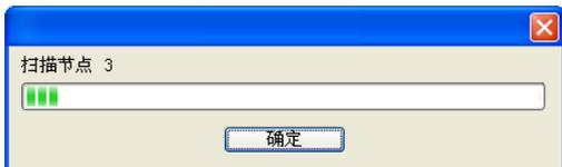
6. 如果上述对话框的进度条一直没有动作，则说明 PC 和 SV PLC 通讯连接不正常或 PC 上有其它程序正在使用串口。此时，网络中被扫描到的所有节点的图标和设备名称都会显示在软件接口中，如下图所示。在此范例中 DVPDNET 的节点地址为 01。
