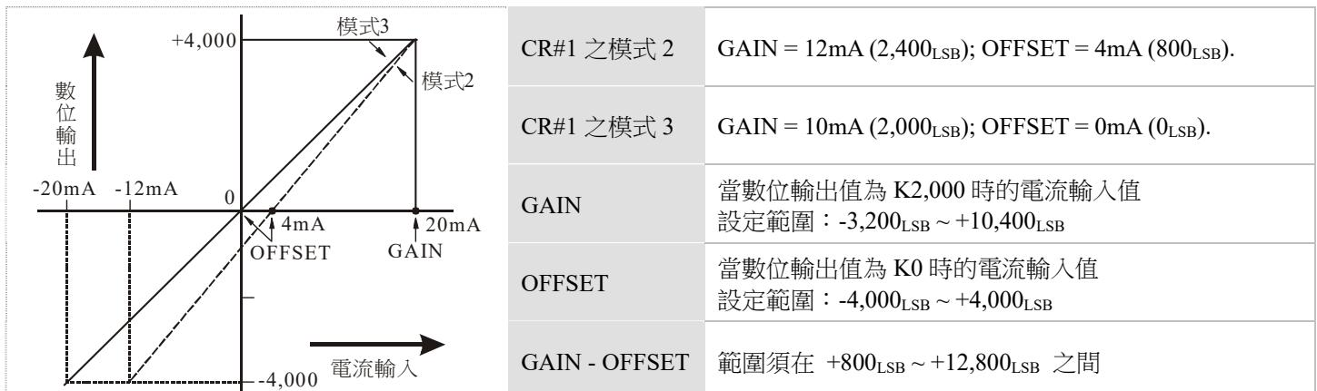
上列表示電壓輸入模式與電流輸入模式之 A/D 轉換特性曲線，使用者可依據實際應用需要來調整轉換特性曲線，調整時以改變 OFFSET 值 (CR#18 ~ CR#21) 及 GAIN 值 (CR#24 ~ CR#27) 來進行。
